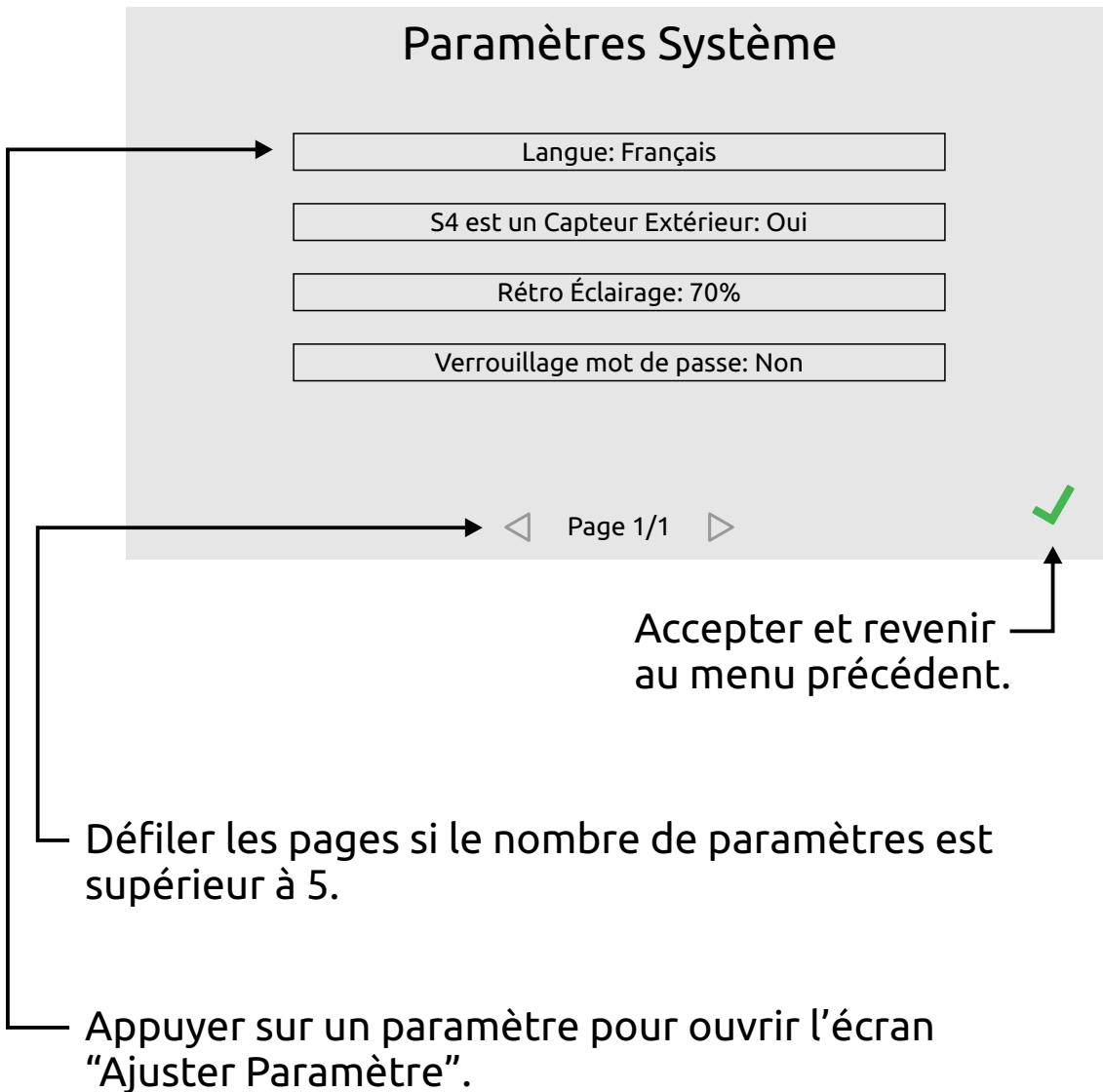
L'écran des paramètres système est montré ici en exemple. Tous les écrans "paramètres" fonctionnent de la même façon. Le titre et la liste des paramètres affichés seront différents d'un écran à l'autre.
